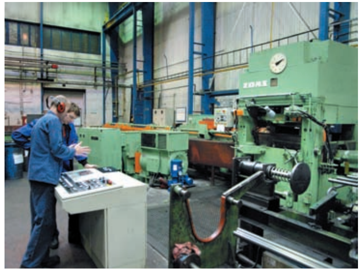
Hladicí rovnačka XRK 2-80 slouží vedle rovnání také k povrchové úpravě tyčí.
