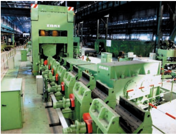
Rovnačka XRK 2-300 je největším typorozměrem dosud vyrobeným ve ŽĐAS, a.s.
