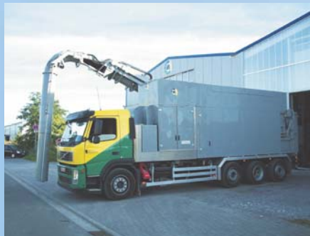
Volvo: zásobník 25 m 3 , savice o průměru 50 cm, hydraulické rameno výsuvné až na 7 m od osy vozidla, ventilátor nasaje až 36 000 m 3 za hodinu
