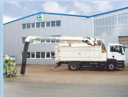
MAN: zásobník 16 m 3 , savice o průměru 40 cm, hydraulické rameno výsuvné až na 6,1 m od osy vozidla, ventilátor nasaje až 28 000 m 3 za hodinu
